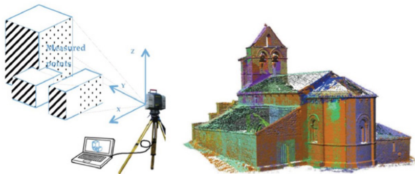
شکل ۱. جمع‌آوری داده به روش اسکن لیزری
