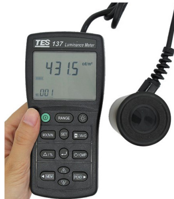
شکل ۵. لومیننس‌متر مورد استفاده در پژوهش
