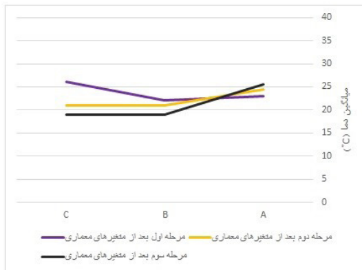
شکل ۱۰. وضعیت دمای هوا در نقاط آزمون بعد از مداخله
